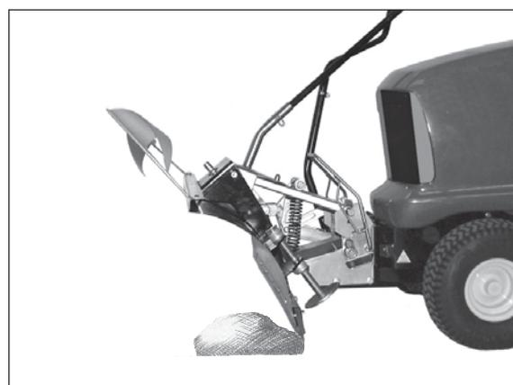
2) Räumschild-Unterkante schwenkt nach hinten. Sicherheits- Klappmechanismus ausgerastet.
